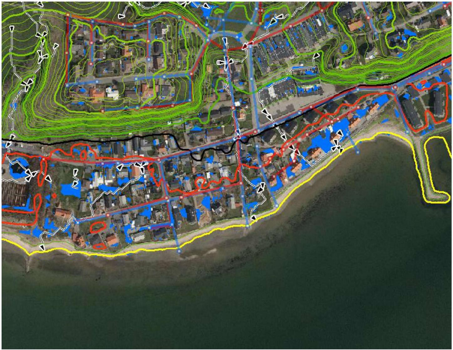
Den gule bugtede streg viser forløbet af kote 0, den røde kote 2 og den sorte kote 3. De sorte pile viser natrige vandstrømme fra baglandet. Blå felter viser, hvor dette vand ville samle sig uden et regnvandssystem (de blå stregen).
